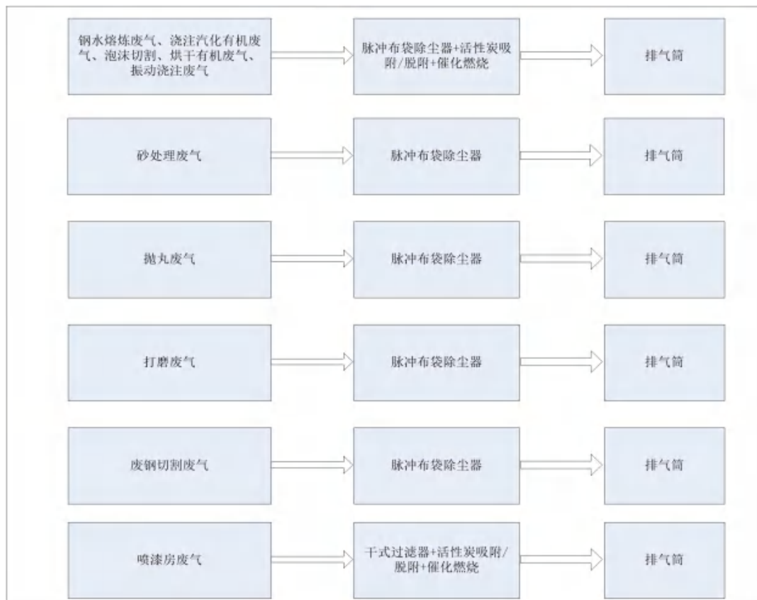
图 4.1-1 废气治理工艺流程示意图
