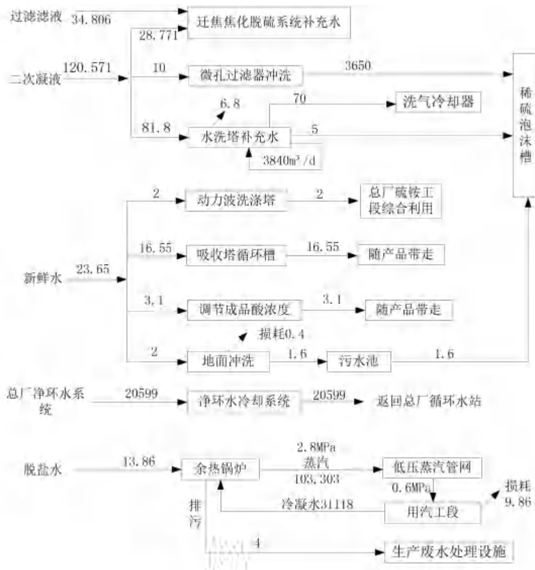
图 3.6-1 工程水平衡图(单位: \text{m}^3/\text{d} )
