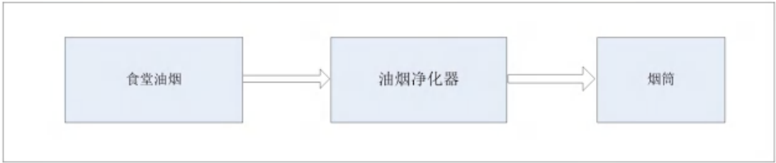
图 4.1-2 废气治理工艺流程示意图
