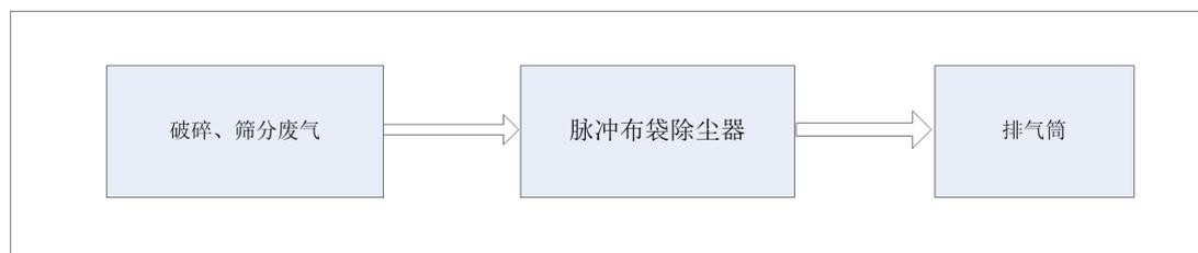
图 4.1-2 废气治理工艺流程示意图
