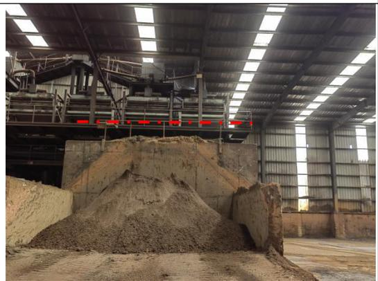
1#磨选生产线入料口喷雾抑尘设施
