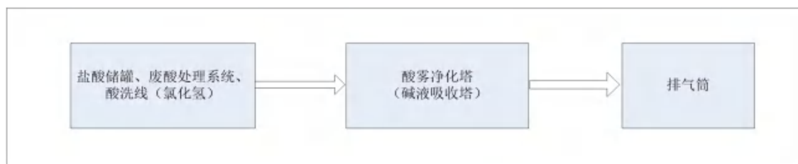
图 4.1-1 废气治理工艺流程示意图
