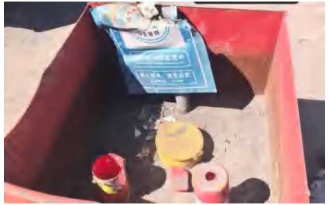
地下水监测井
